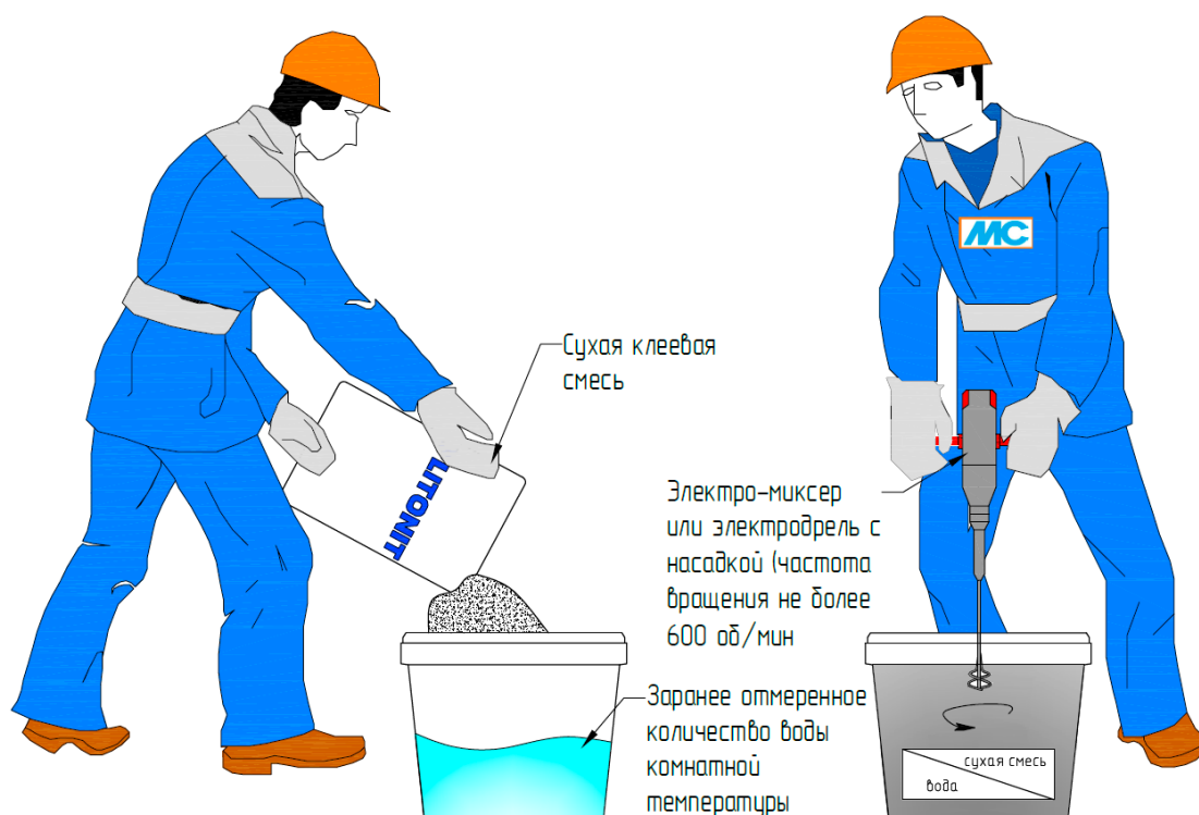
Рис. 11. Организация работ по затворению сухой клеевой смеси
